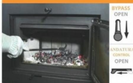
1) con canna fumaria e stufa calda il processo di ricarica richiederà minor tempo. Al termine della combustione prima della ricarica, spegnete le ventole, aprite la porta e con un ferro mescolate e spargete le braci.
