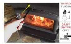
Una volta che il fuoco si sarà stabilizzato, aggiungete grandi ciocchi sul focolare, fate una carica generosa. In genere, dopo 20-30 minuti dovresti essere in grado di chiudere la serranda di bypass con temperature a livello "attivo" zona (oltre 500° F, 260° C).
