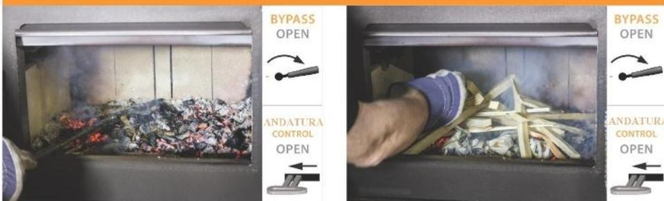
1) con canna fumaria e stufa calda il processo di ricarica richiederà minor tempo. Al termine della combustione prima della ricarica, spegnete le ventole, aprite la porta e con un ferro mescolate e spargete le braci.
