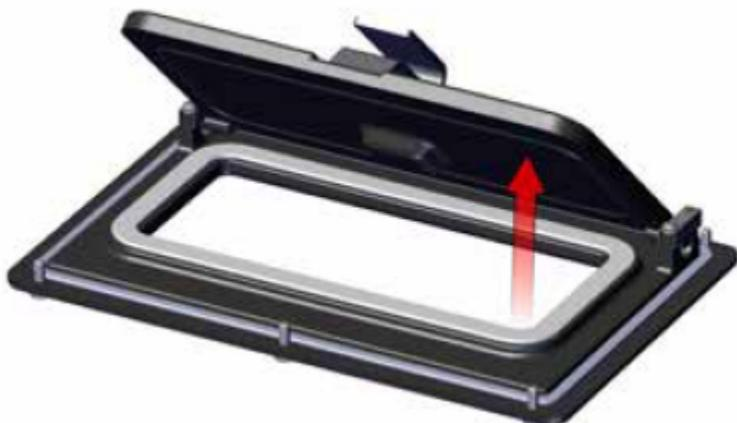
**Rimuovete la vecchia guarnizione con cura e sostituirla con la nuova.**
