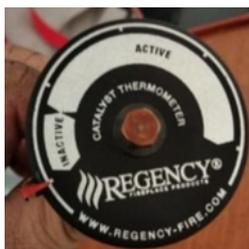
Il termometro del catalizzatore indica solamente la temperatura del flusso dei fumi quando attraversano il catalizzatore. Il termometro inserito nel foro, deve esser pulito almeno una volta all'anno con carta vetrata 220.
