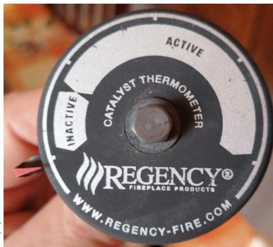
**CONTROLLATE SEMPRE CHE A FREDDO L'INDICATORE ROSSO DELLA TEMPERATURA SIA LEGGERMENTE SOTTO INACTIVE... SE SI DISCOSTA VA RIPOSIZIONATO ALLENTANDO I 2 BULLONI SOPRA E SOTTO E DOPO IL RIPOSIZIONAMENTO RISERRATE I BULLONI !**
